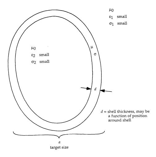
Fig. 9.1. Thin-Shell Target
