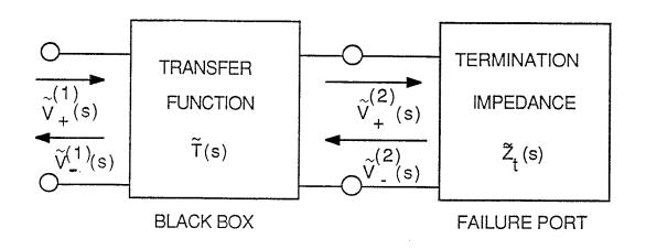
FIG. 2.1 BLACK BOX MODELLED AS LINEAR FILTER
